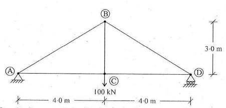
ऊपर दिये गये चित्र में प्लेन ट्रस (कैंची) के जोड़ B के लिए ऊर्ध्वाधर विक्षेपण का परिकलन एकल भार विधि के द्वारा कीजिए I ट्रस के सभी अवयव समांगी अनुप्रस्थ-काट एवं पदार्थ वाले हैं I Calculate the vertical displacement of joint B of plane truss given in the above figure by unit load method. All members of truss have constant cross-sectional area and same material (Constant A & E).
